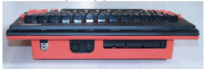
Die Schnittstellen: HF, Tape & RGB, Centronics und Systembus
